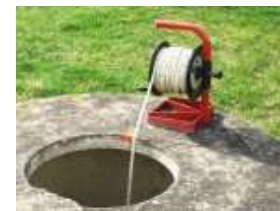
Mesure à l'aide d'une sonde piézométrique manuelle (source : BRGM)
